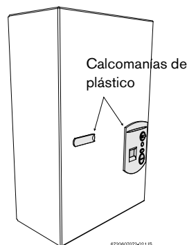
Fig. 3 Retirada de la cubierta frontal
