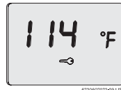
Fig. 28 Estado de bloqueo
